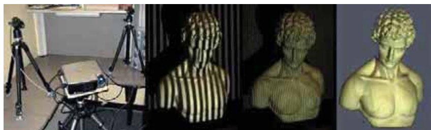
Рис. 8 Сканирование бюста сканером структурированного света
