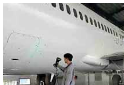
Рис. 10 Оцифровка объекта при помощи ручного лазерного сканера
